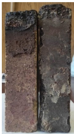
Рис. 4. Кирпичи из переклазохромита после года эксплуатации с характерными признаками коррозионного разрушения:
