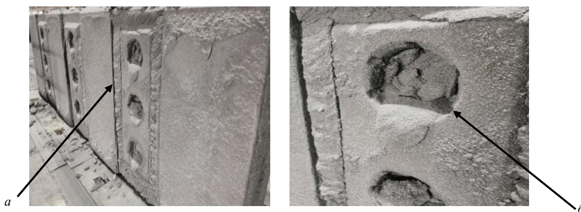
Рис. 3. Дефекты обожженных анодов: а – прикоксовка анодов; б – дефекты nipple-ных гнезд
