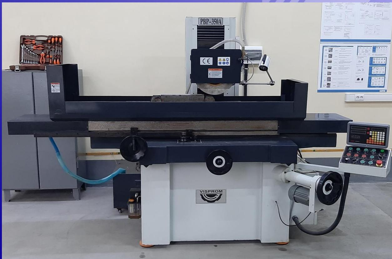
Максимальные размеры заготовки 305×1020×400 мм
