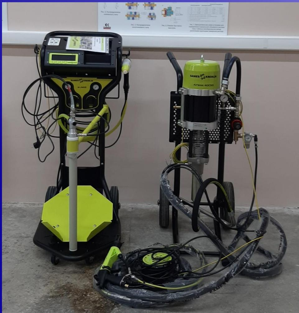
Покраска высоковязкими материалами на основе воды и с высоким содержанием твердых частиц
