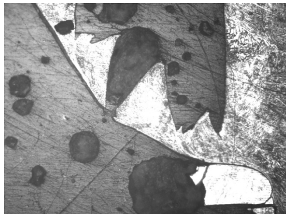
Рис. 8. Корень стружки при скорости резания 80 м/мин, время резания 3 мин; х 70
