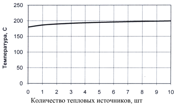
Рис. 3. Влияние аккумуляции теплоты на температуру на поверхности отверстия
