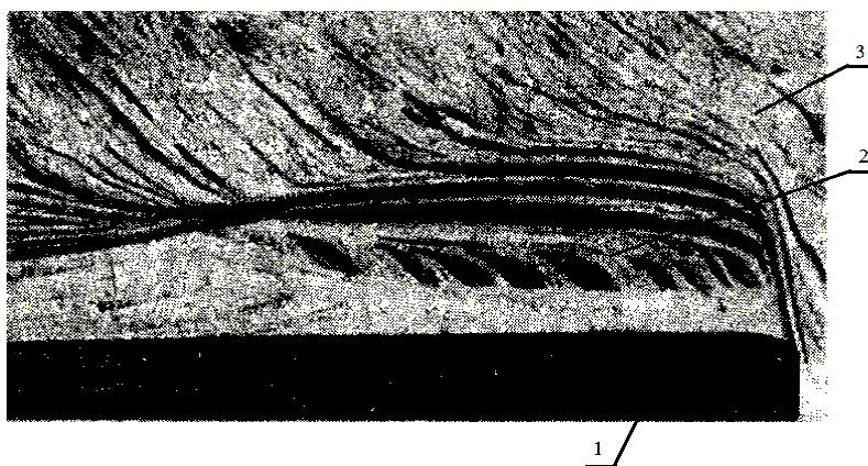
Рис. 5. Микрошлиф корня стружки [3]: 1 – твердый сплав ВК6; 2 – зона относительного застоя; 3 – сталь 12Х18Н10Т ( V = 22,5 м/мин, S = 0,3 мм/об, t = 1,5 мм)
