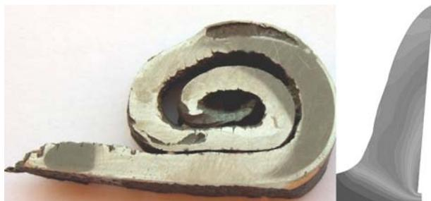
Рис. 3. Сравнение стружки, полученной в производственных условиях со стружкой, полученной при моделировании
