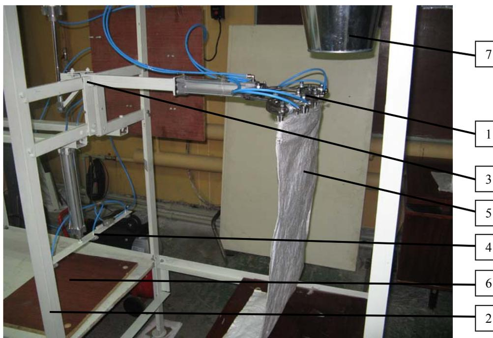
Рис. 1. Общий вид экспериментального устройства для автоматического наполнения гибких контейнеров сыпучим материалом
