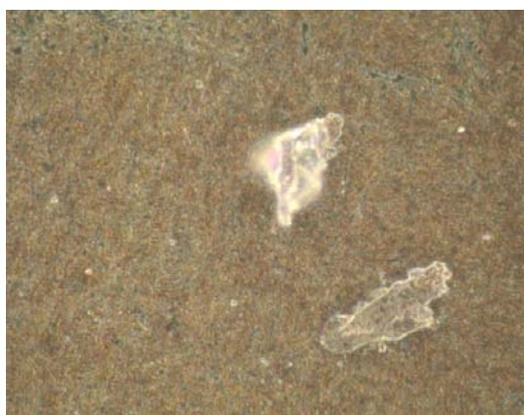
Рис. 3. Силикат SiO<sub>2</sub> в стали 20X2H4MФ, ×1000
