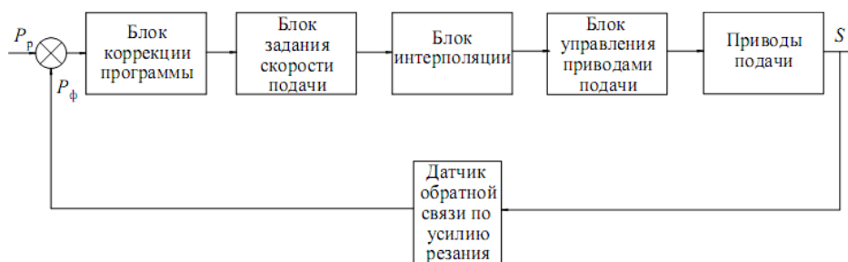
Рис. 2. Функциональная схема регулирования подачи в типовой системе ЧПУ
