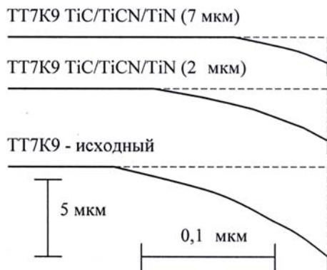
Рис. 5. Профилограммы передних поверхностей сплава ТТ7К9 с покрытием различной толщины после кратковременного фрезерования стали ХВГ ( S = 0,2 мм/зуб; V = 240 м/мин)
