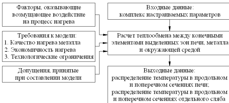
Рис. 2. Структурная схема математической модели процесса нагрева слябов в методической печи
