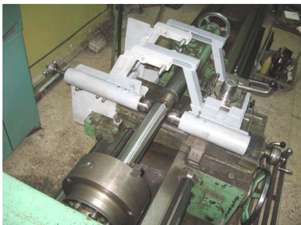
Рис. 2. Приспособление для токарной обработки с ОПД (главный вид)
