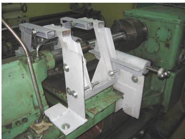
Рис. 3. Приспособление для токарной обработки с ОПД (вид сбоку)
