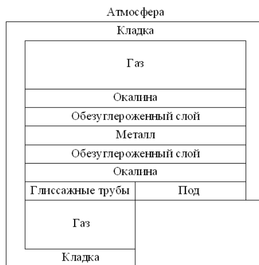
Рис. 1. Схематичное представление методической печи с нагреваемыми слябами для тепловых расчетов
