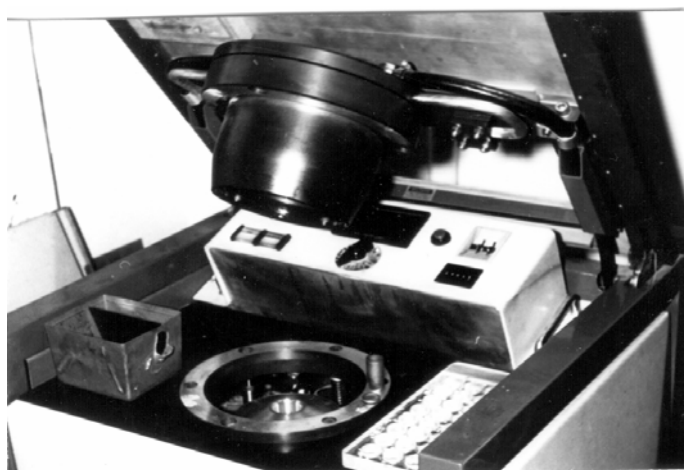
Рис. 2. Принципиальная схема и внешний вид вакуумной установки для анализа экстрагированного газа: 1 – образец; 2 – вакуумная печь; 3 – форвакуумный насос; 4 – газосборочный насос; 5 – газосборник; 6 – газовый хроматограф; 7 – калиброванный объем
