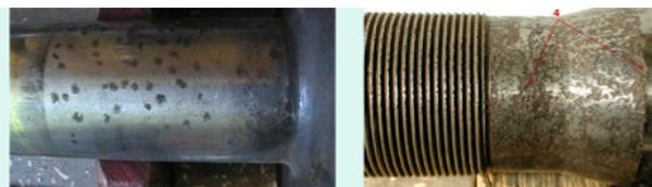
Рис. 3. Шток компрессора Creaseau Loire после длительной эксплуатации
