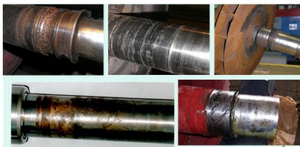
Рис. 2. Примеры предельно изношенных деталей оборудования: роторы турбин, ГПА, ГТУ, газодувок, электродвигателей, валы насосов, плунжеры, штока компрессоров, коленчатые валы и т. п.
