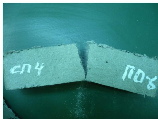
Рис. 2. Разрушенный образец пенофибробетона с использованием полипропиленовой фибры, суперпластификатора «Полипласт СП-4» и пенообразователя «ПО-6»
