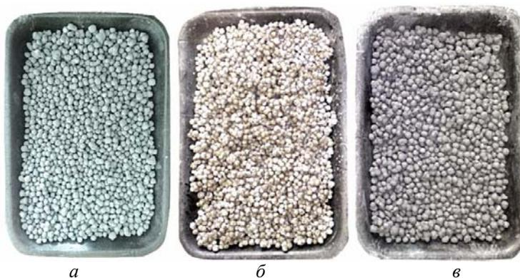
Рис. 2. Гранулы пенополистирола, плакированные жидкостекольным покрытием с добавкой ПАВ и дисперсных порошков:
