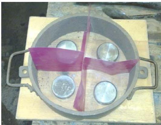
Рис. 5. Модельная плита с установленными моделями, опокой и разделителем смесей
