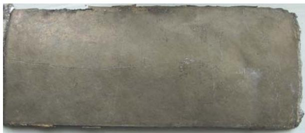
Рис. 1. Макроструктура сваренного взрывом КМ МА2-0–АД1 с поверхности магния
