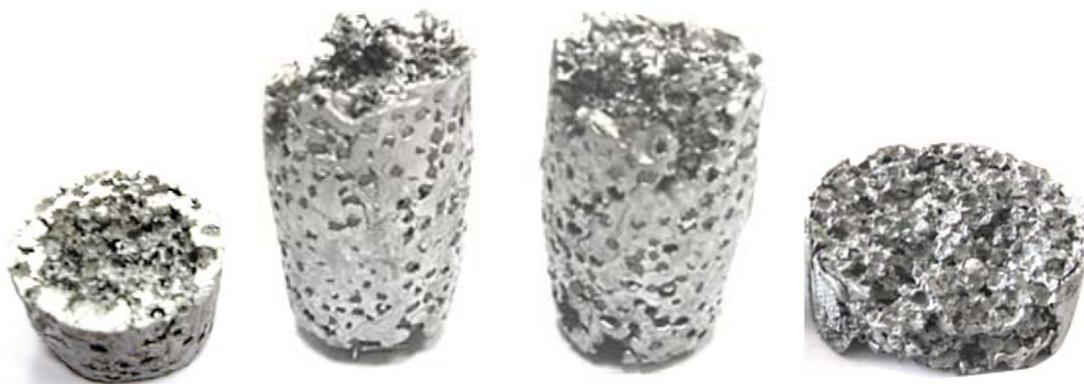
Рис. 6. Образцы опытных пористых (пеносилуминовых) заготовок: крайние слева и справа – вид заготовок в разрезе
