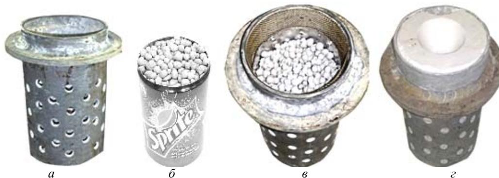
Рис. 4. Фотоснимки опоки (а), фольгового контейнера с засыпкой плакированных гранул пенополистирола (б), опоки с установленным контейнером, заполненным гранулами (в), формы в сборе с литниковой воронкой (г)
