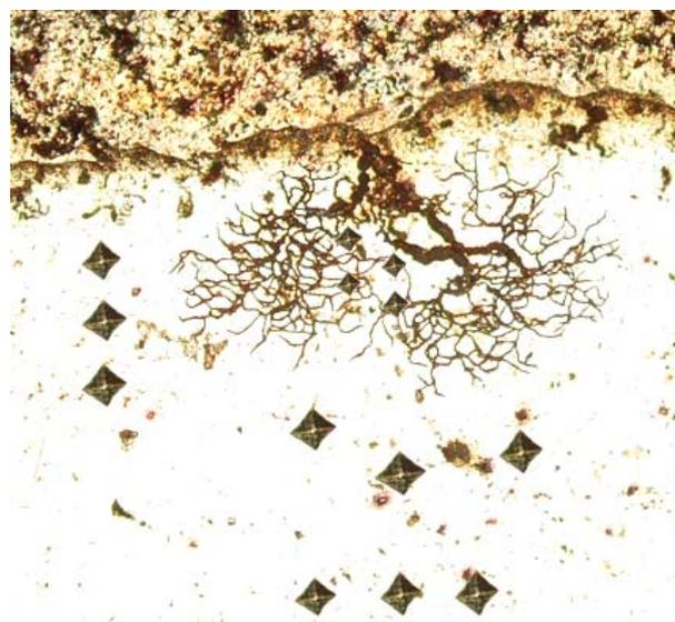
Рис. 4. Вид разветвленной древовидной трещины в МА2-0 с нанесенными отпечатками от алмазного индентора при измерении твердости.  $\times 200$
