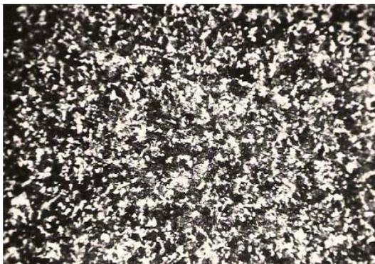
Рис. 1. Гомогенная микроструктура стали 45ФЛ
