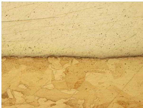
Рис. 1. Микроструктура зоны соединения АД1–НП1 после сварки взрывом ( $\times 200$ )
