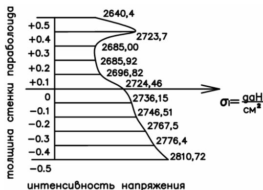
Рис. 3. Эпюра интенсивности напряжений
