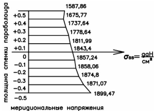
Рис. 2. Эпюра меридиональных напряжений
