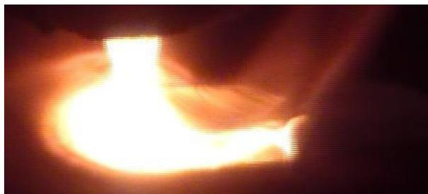
Рис. 2. Отставание анодного пятна при сварке неплавящимся электродом
