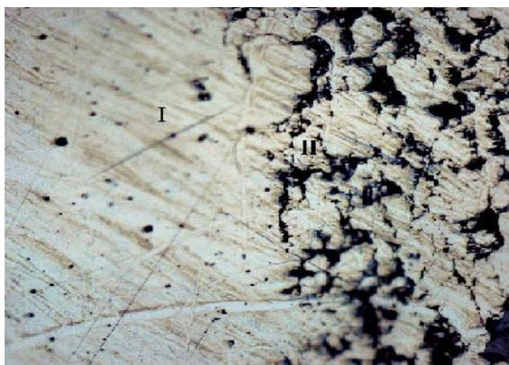
Рис. 1. Микроструктура композита 30 % Φ-4 + 70 % Ni (x200):
