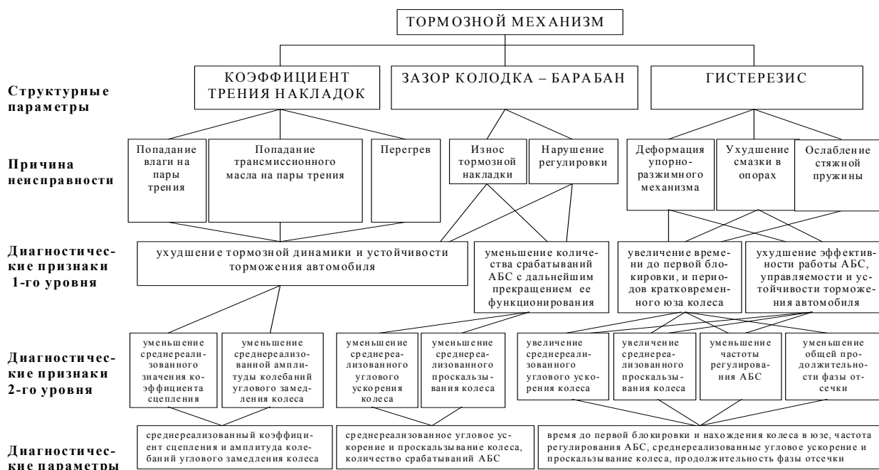
Рис. 1. Структурно-следственная схема для диагностирования тормозного механизма автомобиля с пневматической тормозной системой, оснащенной АБС
