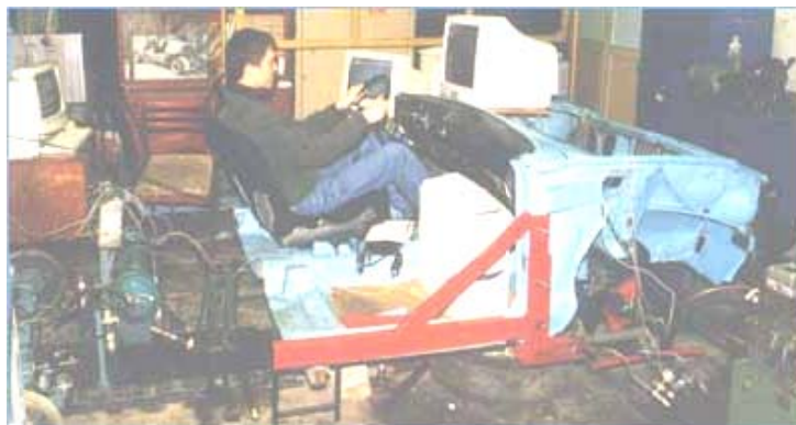
Стенд, позволяющий проводить виртуально-физические испытания автоматизированных тормозных систем и элементов шасси автомобиля
