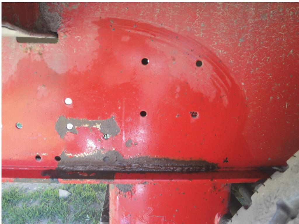
Рис. 2. Вид усталостной трещины рамы полуприцепа, устраненной сваркой
