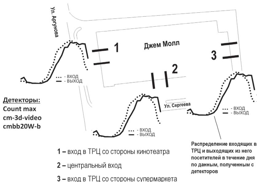
Рис. 1. Схема размещения входов в ТРЦ с установленными детекторами входа (выхода)
