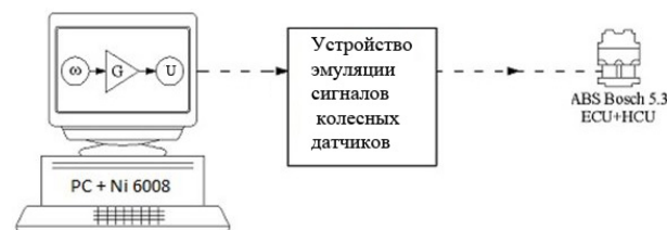
Рис. 1. Связь устройства с ПК с подключенным к нему УСД и АБС Bosch 5.3
