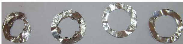
Рис. 2. Образцы плоских кольцевых фольг после электрического взрыва при различных начальных напряжениях конденсаторной батареи
