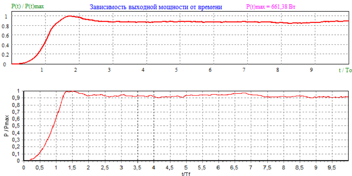
Рис. 4. Временная зависимость уровня выходной мощности, нормированного по отношению к максимальной мощности
