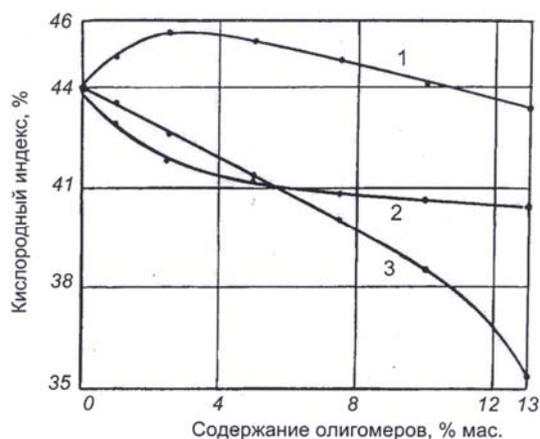
Рис. 2. Зависимость кислородного индекса ПВХ от содержания олигомерных модификаторов:
