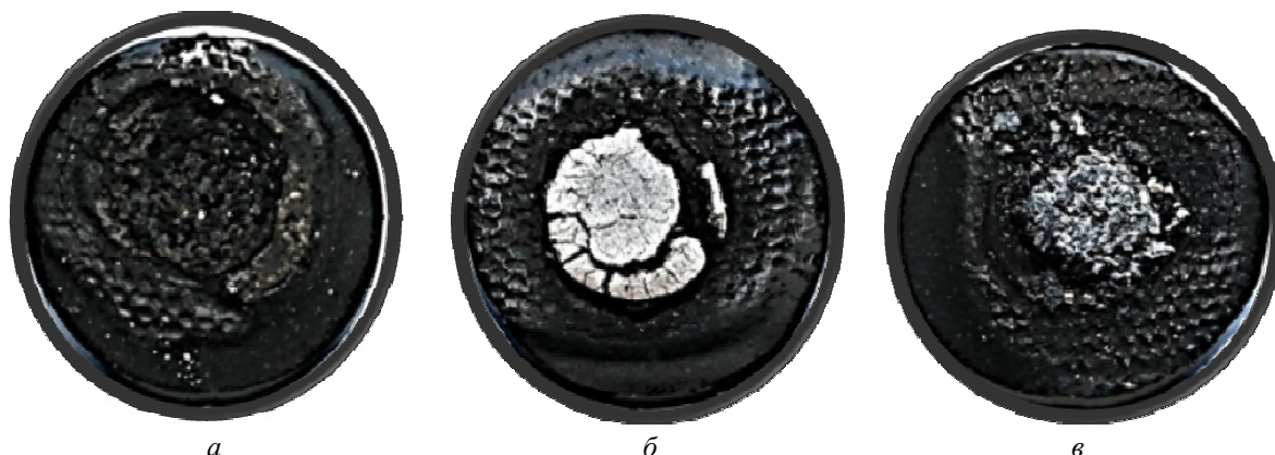
Рис. 2. Вид образца после прогрева в течение 3 минут: а – контрольный образец; б – опытный образец Z-1; в – опытный образец Z-2
