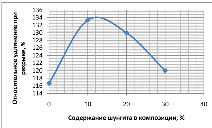
Рис. 4. Зависимость относительного удлинения при разрыве, % от количества шунгита в композиции на основе сополимера изопрена и бутадиена марки ПДИ-1К
