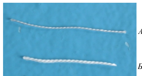
Образцы полиэфирных нитей после выдержки в воде в течение 24 часов: А – исходная нить, Б – модифицированная полиэфирная нить
