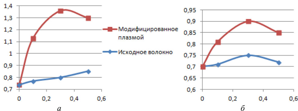
Рис. 4. Исследование влияния модификации плазмой полиамидных волокон на адгезионные свойства клея 88-СА при склеивании резин на основе СКИ-3 (а) и СКЭПТ-40 (б)
