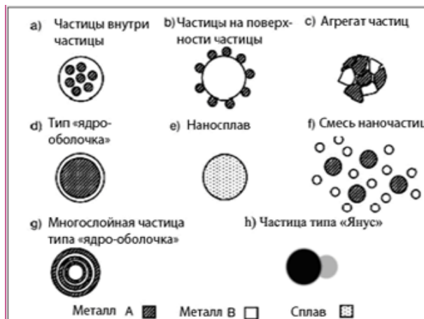
Рис. 4. Морфология биметаллических наночастиц [3])
