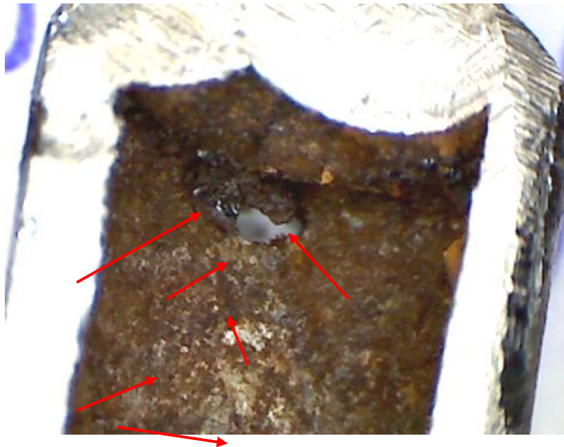
Рисунок 3.6. Отложения на стенках каналов и выходных отверстий пилонов
