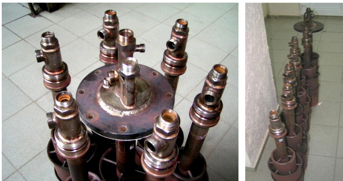
Рисунок 1.1. Комплект горелочных устройств
