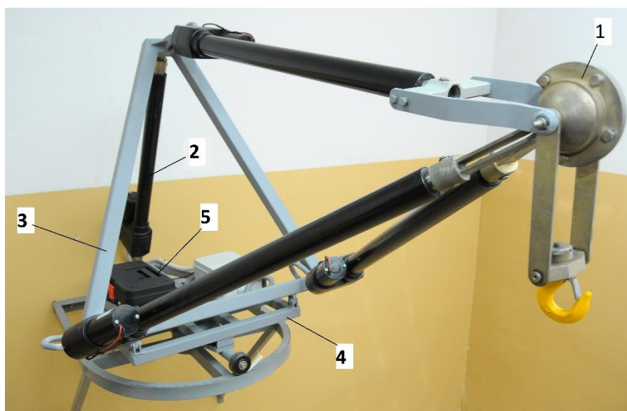
1 - четырехподвижный шарнир, 2 - актуаторы SFK САНВ-21 , 3 - поворотное основание, 4 – платформа, 5 - микрокомпьютер Raspberry
