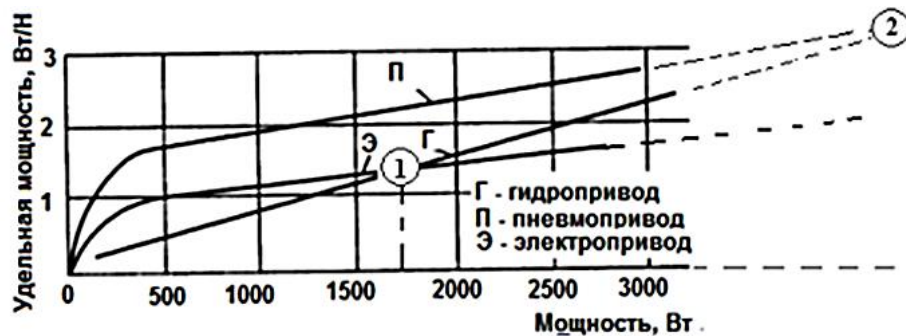
Рисунок 1.4 – Удельная мощность (отнесенная к весу) различных систем приводов в зависимости от абсолютной мощности
