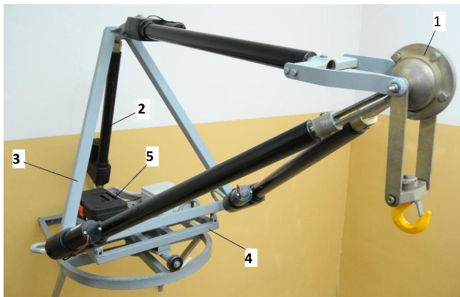
1 - четырехподвижный шарнир, 2 - актуаторы *SFK CAHB-21*, 3 - поворотное основание, 4 – платформа, 5 - микрокомпьютер *Raspberry*
