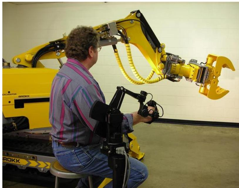
Рисунок 1.17 – Копирующая система управления Kraft
