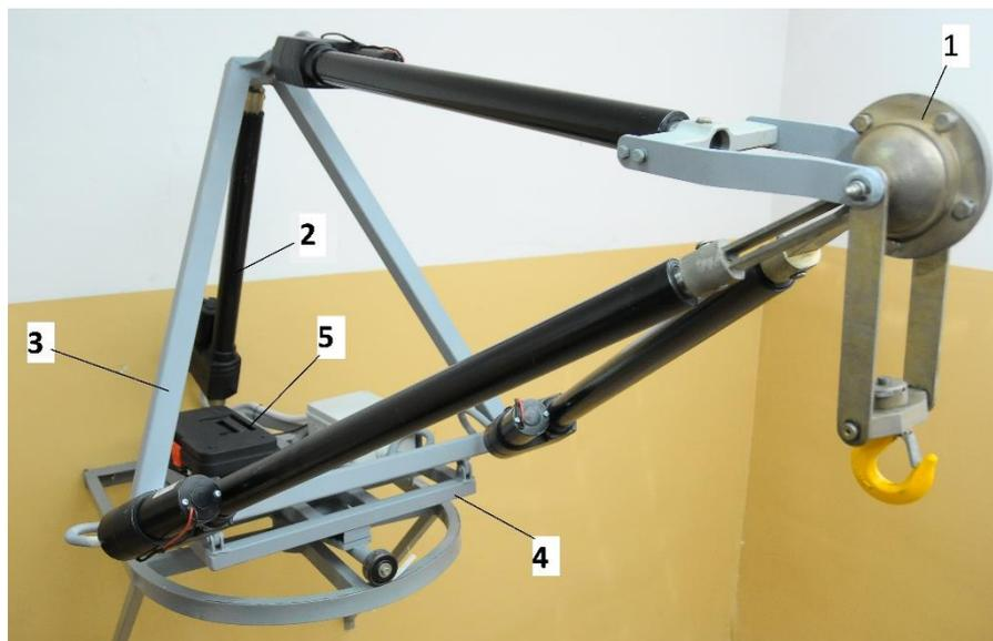
1 - четырехподвижный шарнир, 2 - актуаторы *SFK САНВ-21*, 3 - поворотное основание, 4 – платформа, 5 - микрокомпьютер *Raspberry*
