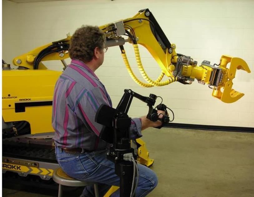
Рисунок 1.17 – Копирующая система управления Kraft
