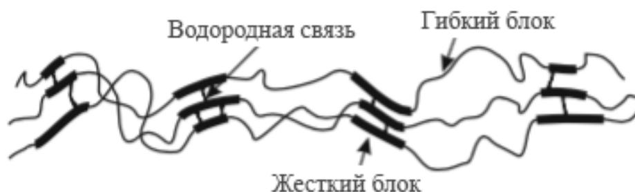
Рисунок 1.4 – Схема блочной структуры полиуретанов
