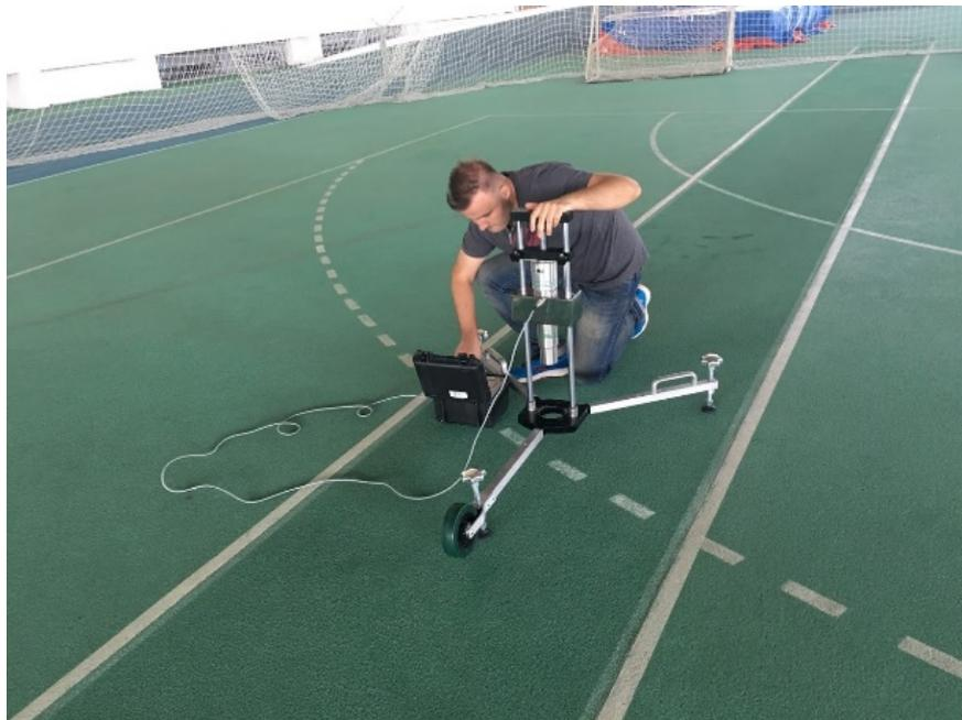
Рисунок 6.2 – Определение показателя «гашение силы» полиуретанового покрытия сектора для прыжков с шестом легкоатлетического манежа ВГАФК
