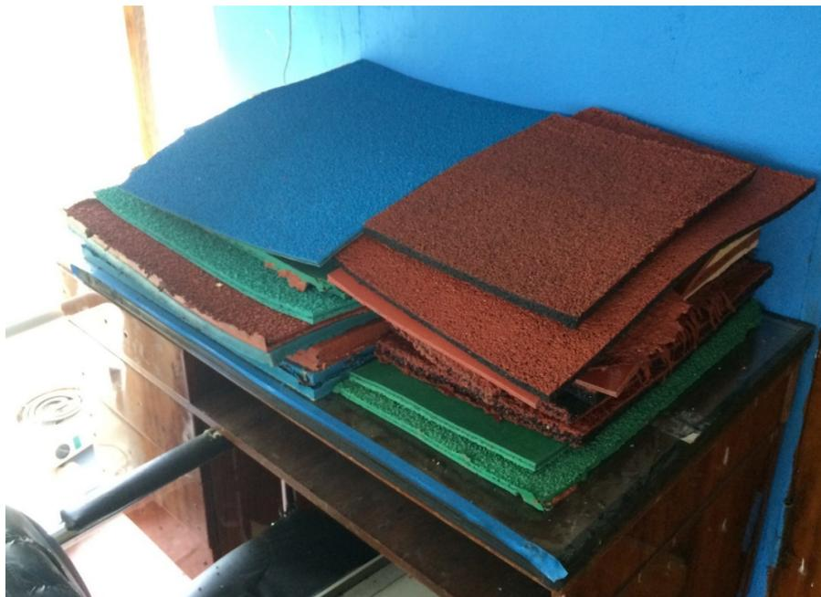
Рисунок 6.1 – Образцы полиуретановых покрытий для определения показателей «гашение силы» и «вертикальная деформация»
