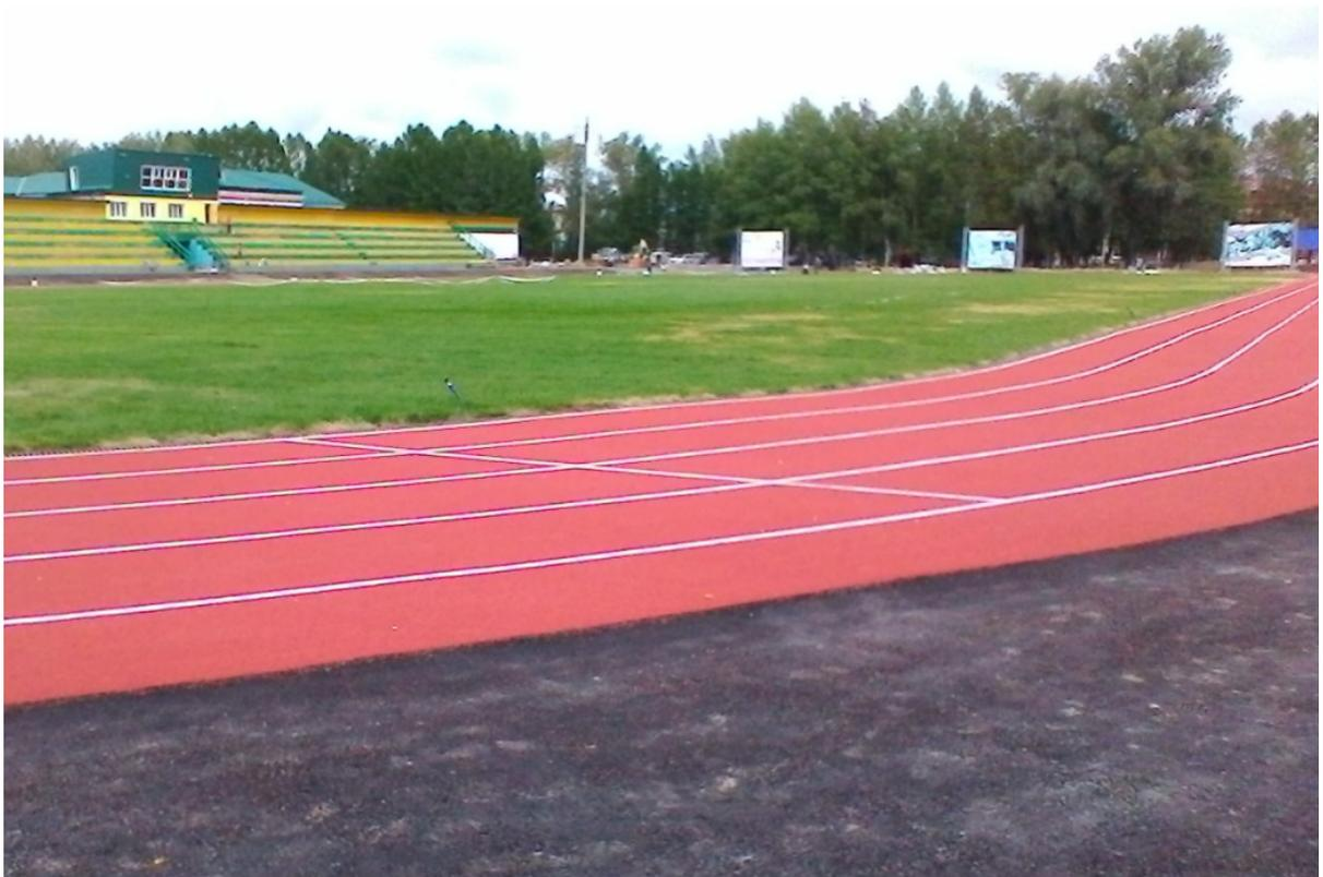
Рисунок 6.4 – Беговые дорожки легкоатлетического стадиона в г. Колпашево (Томская область), изготовленные из морозостойкого ЭПДУ
