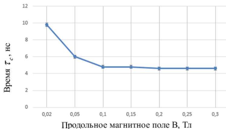
Рисунок 3.9 – Зависимость времени образования виртуального катода от величины фокусирующего магнитного поля
