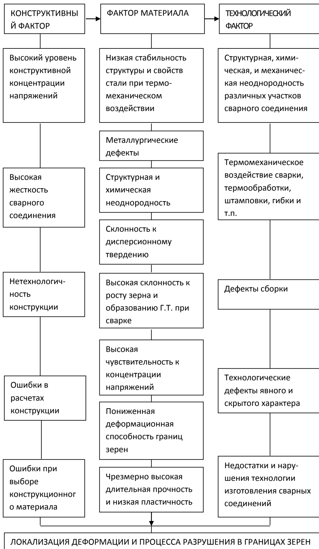
Рисунок 1.3 - Структурная схема факторов межзеренной хрупкости
