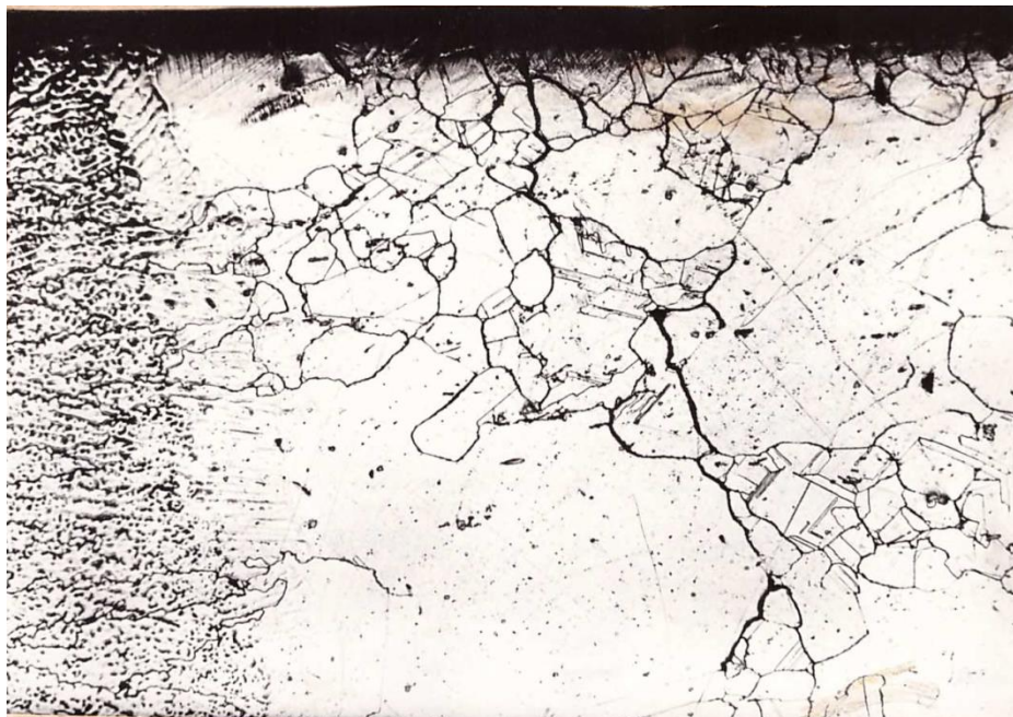
Рисунок 1.9 - Микроструктура межзеренного разрушения металла ЗТВ сварных соединений стали 12X18H12T, X100
