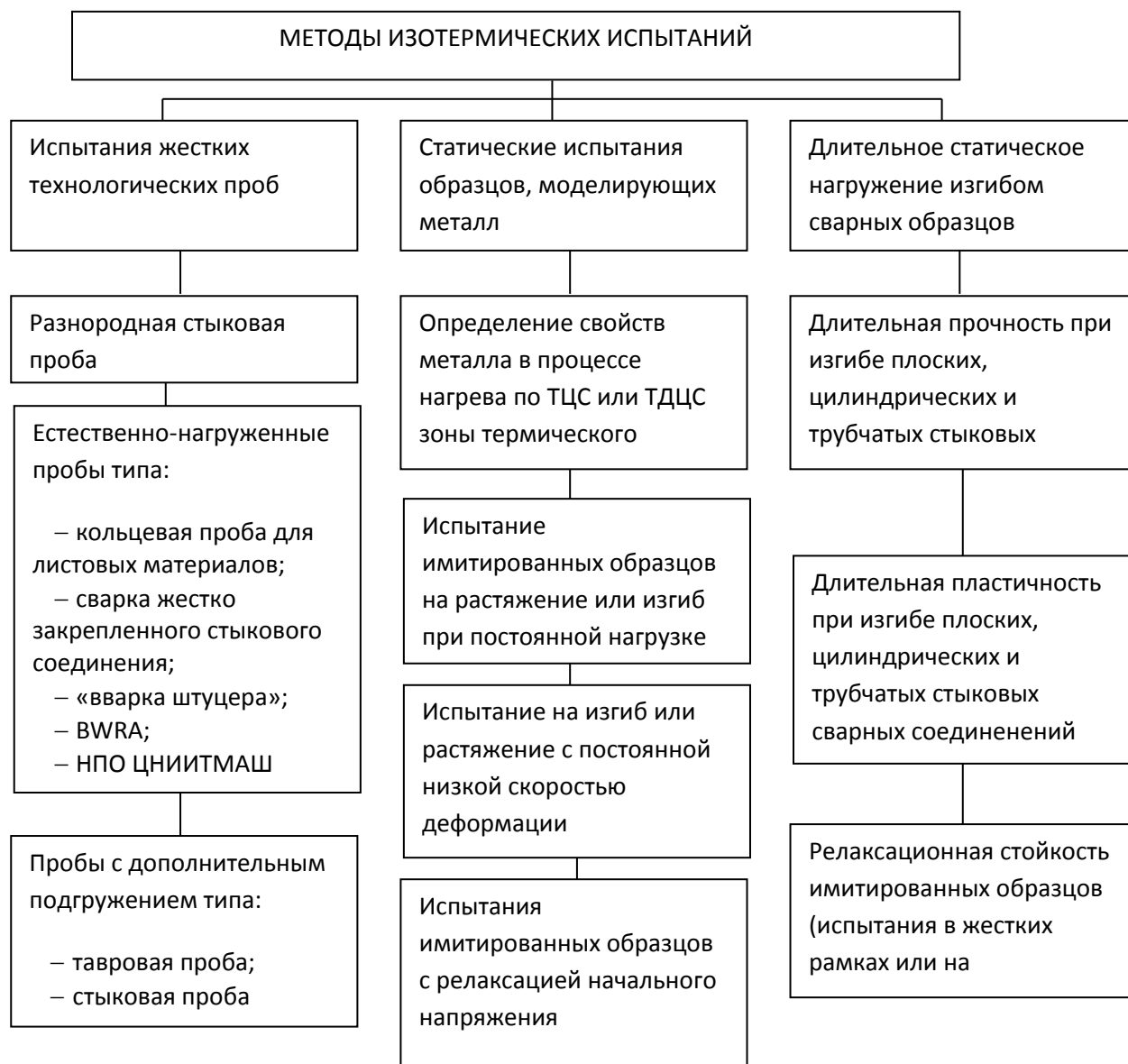
Рисунок 1.12 - Методы определения склонности сварных соединений к ТТО
