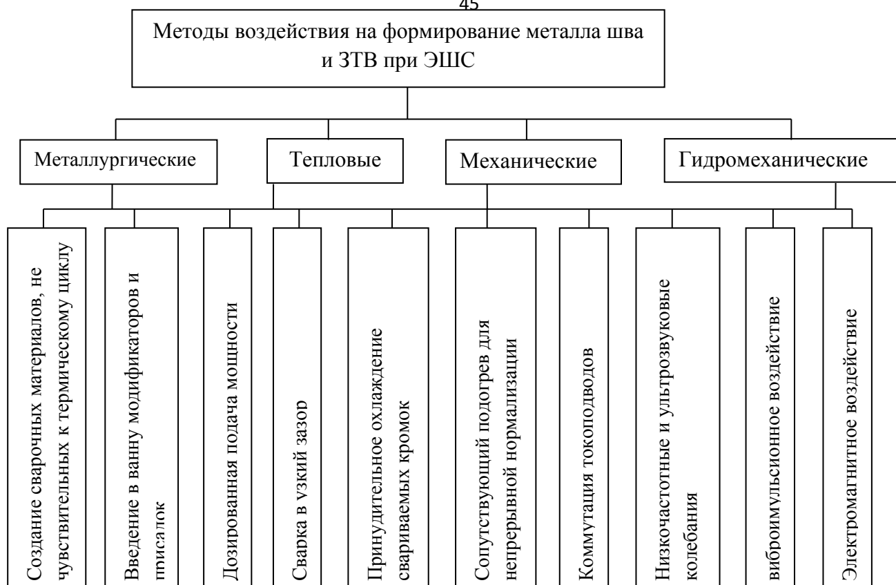
Рисунок 1.21 - Схема технологических приемов и методов воздействия на формирование металла шва и ЗТВ при ЭШС [22]
