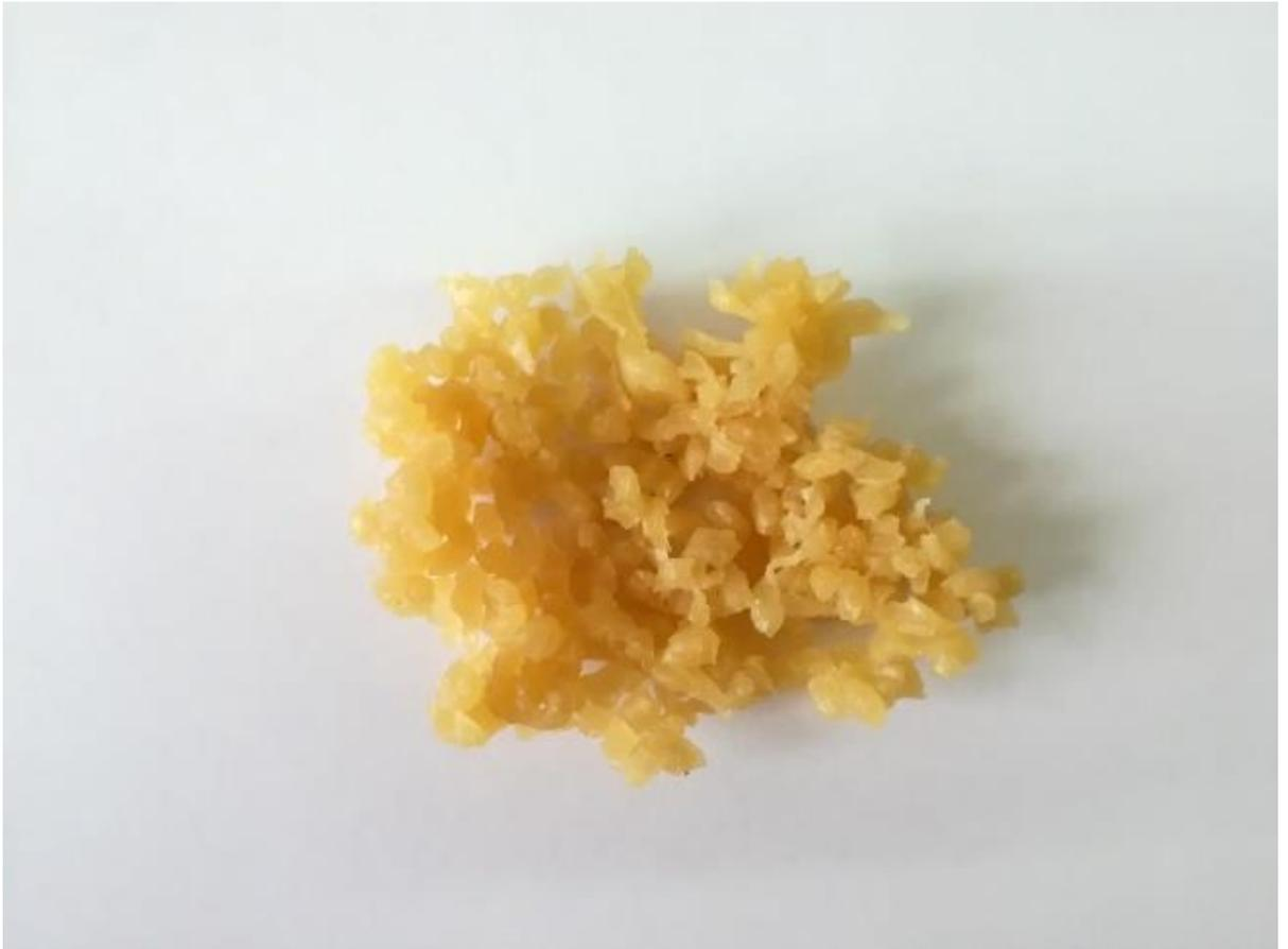
Рисунок 2.2 – Образец смеси НК/ПВХ 80/20
