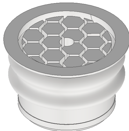
Рис. 5. Вакуумная присоска с опорной сотовой поверхностью диаметром 100 мм
