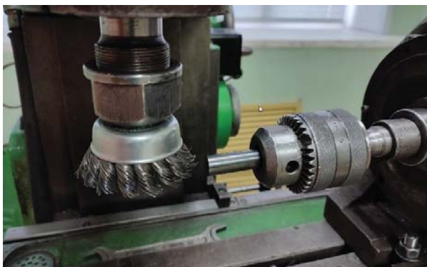
Рис. 1. Фотография установки для полирования поликристаллического алмазного покрытия цилиндрической поверхности
