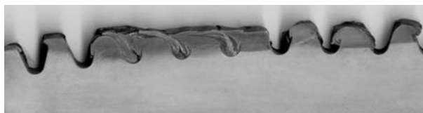
Рис. 1. Фрагмент пилы с деформированными зубьями
